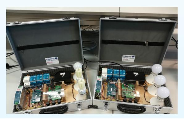
Nous avons examiné la faisabilité de la CPL en nous concentrant sur les perturbations ou interférences électromagnétiques (IEM). Les interférences sont dues au fait que chaque appareil électronique dégage des champs électromagnétiques, souhaités ou non, ou en émet par l'intermédiaire du câblage. D'autres appareils peuvent alors recevoir ces champs, ce qui crée des effets indésirables dans leur fonctionnement.
