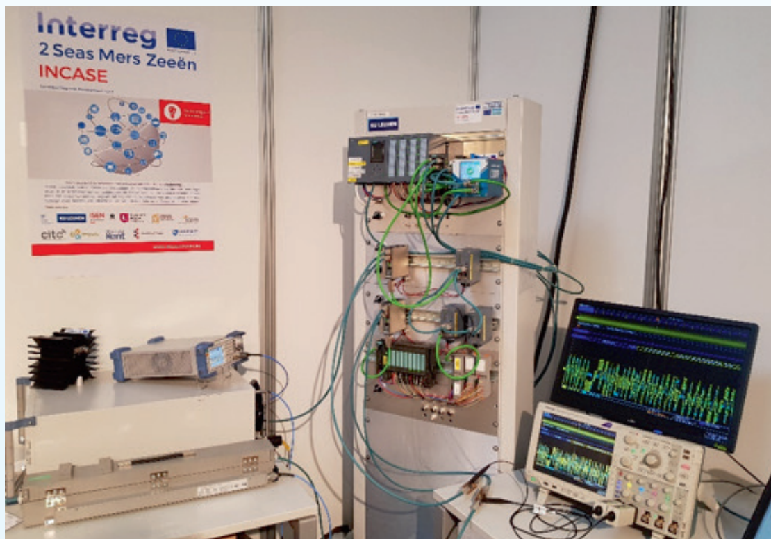
Demonstratie-opstelling op Indumat 2019: inkoppeling van EMI op een redundant PROFINET netwerk.
